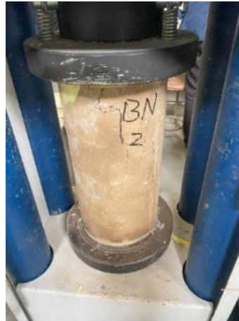
Gambar 4.27. Pengujian Kuat Tekan Beton (Sumber : Hasil Penelitian, 2025)
