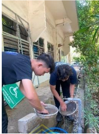
Gambar 4.7. Kadar Lumpur Agregat Halus Cara Pencucian (Sumber : Dokumentasi Penulis, 2024)
