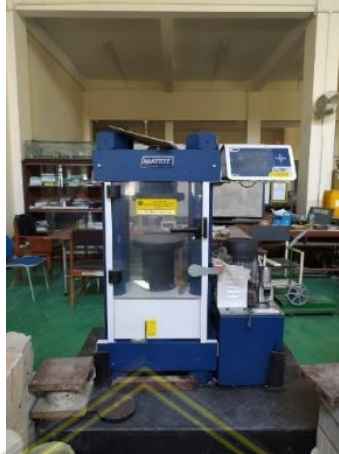
Gambar 3.14. Compression Testing (Sumber : Dokumentasi Penulis, 2024)
