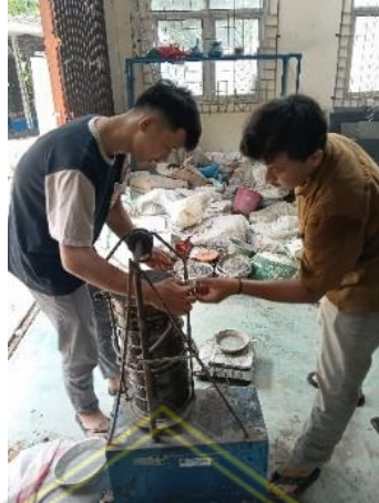
Gambar 4.17. Analisa Saringan Agregat (Sumber : Dokumentasi Penulis, 2024)
