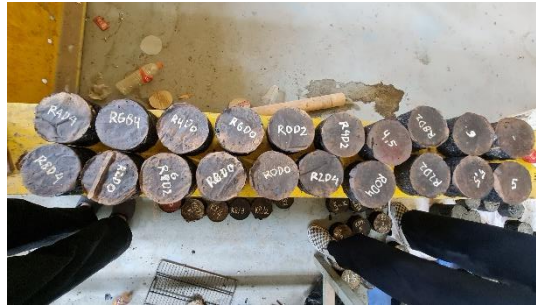
Gambar 4.13. Benda Uji Variasi Resin Epoxy dan Serat Baja Dramix
