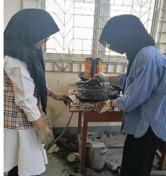
Gambar 4.7. Pengujian Berat Jenis Aspal
