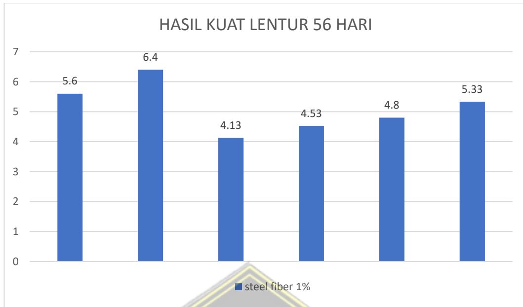
Gambar 4.20 Grafik Hasil Kuat Lentur 56 Hari dengan Kadar Steel Fiber 1%
