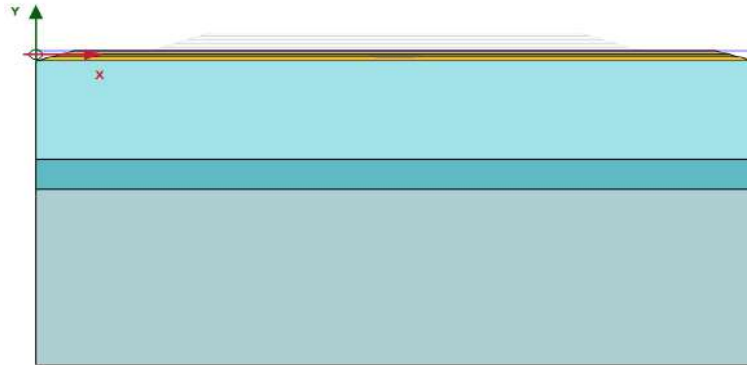
Gambar 4. 17 Permodelan Pekerjaan Konsolidasi Timbunan Sand Drain +1 m
