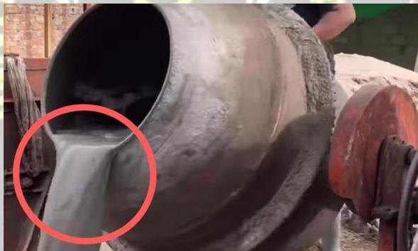
**Gambar 4. 13** Limbah Cair pada Pencucian Mesin Molen
