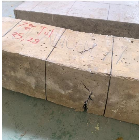
Gambar 4. 10 Pola retakan pada beton bertulang
