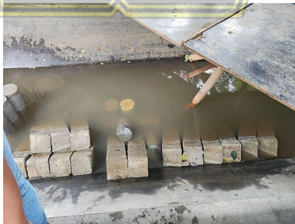
Gambar 4. 4 Perawatan Benda Uji Balok
