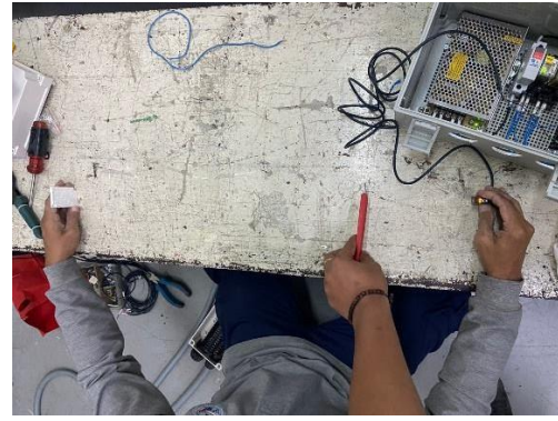
Gambar 4. 11 Pengujian Photo Sensor Ada Barang Jarak 0,5 m
