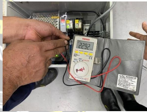
Gambar 4. 13 Pengukuran Tegangan Photo Sensor Ada Barang
