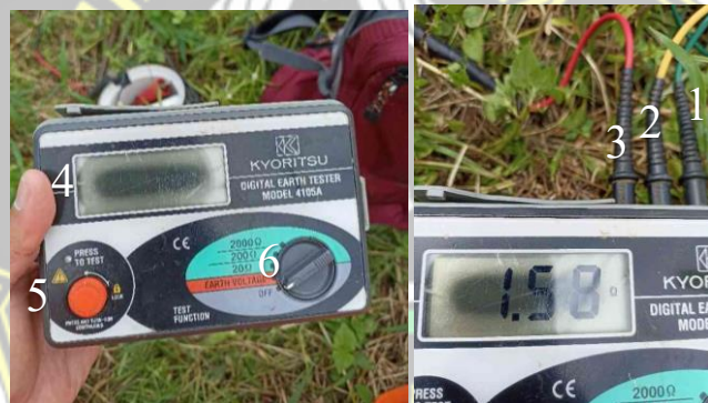
Gambar 3. 2 Earth Resistance Tester dengan Merk Kyoritsu Model 4105A
