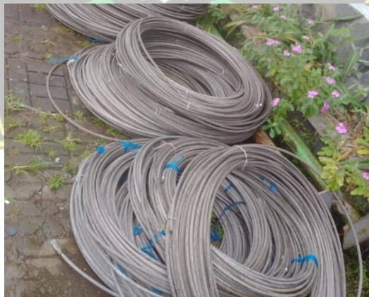
Gambar 2.8 Earth Wire untuk MRG [15]
