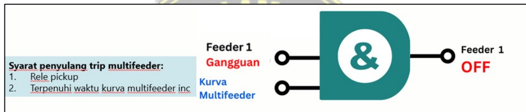
Gambar 4. 11 Rangkaian Logika Skema Setting Multifeeder
