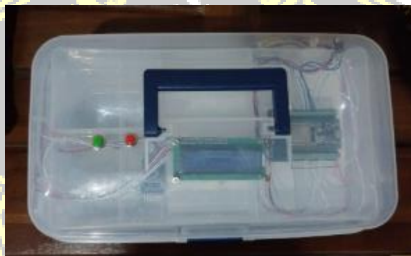
Gambar 4. 1 Rancang Bangun Sistem Monitoring Suhu, Kelembapan, Warna, Dan Waktu Pada Proses Fermentasi Eco Enzyme
