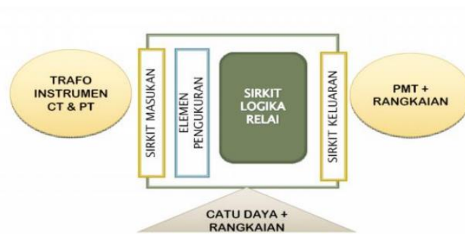
Gambar 2. 14 Komponen Utama Relai Proteksi [6]
