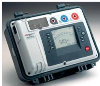
Gambar 2. 16 Alat uji tahanan isolasi [9]
