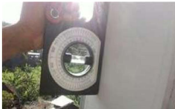
Gambar 2.24 Contoh Pengukuran Mekanikal *Tilting*
