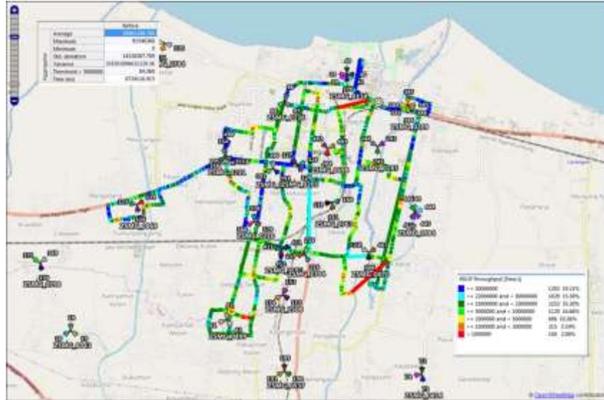
Gambar 4.4 PDCP *Throughput* Sebelum Optimalisasi[18]
