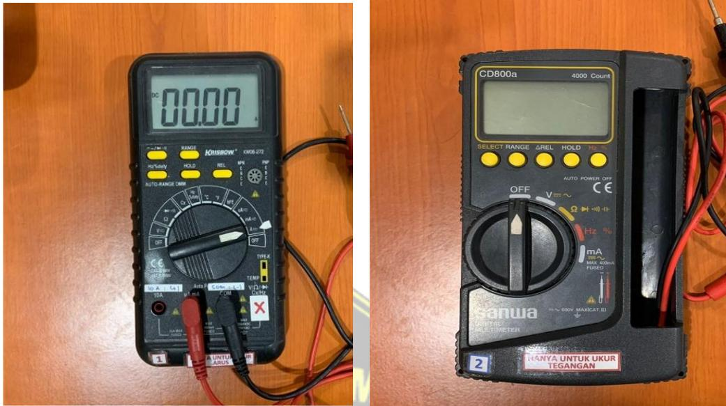
Gambar 3. 7 Multi meter Krisbow KW06-272 dan SANWA CD800a.
