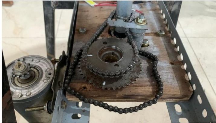
Gambar 3. 3 gear transmisi pada percobaan.
