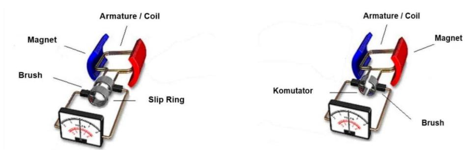
Gambar 2. 5 generator Ac dan generator DC.
