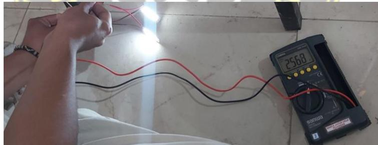
Gambar 4. 5 pengukuran tegangan generator dengan beban terpasang.
