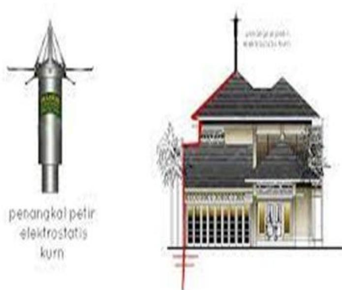
**Gambar 2. 5 Penangkal Petir Elektrostatik**
