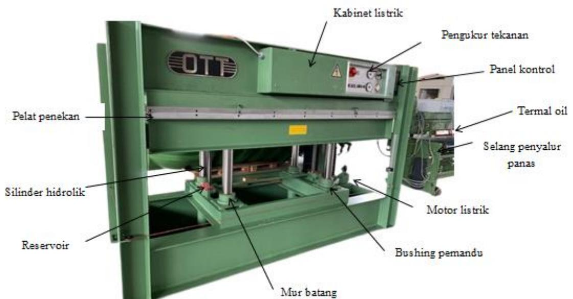
Gambar 4.13 Komponen Mesin *Hot Press* OTT 1 Opening Hidrolik
