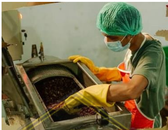
Gambar 4.6 Penggorengan menggunakan mesin vakum
