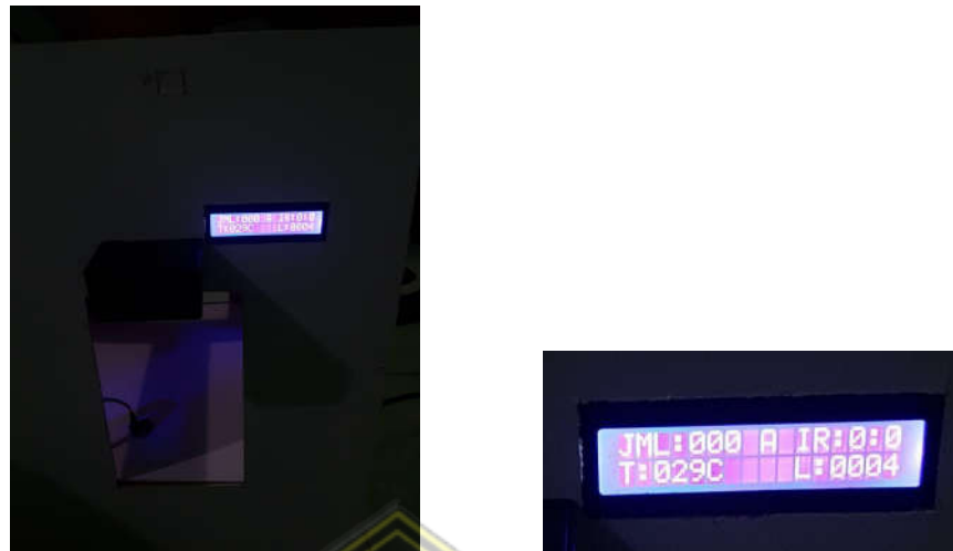
Gambar 4.6 Tampilan LCD ketika tidak terdapat orang dalam ruangan
