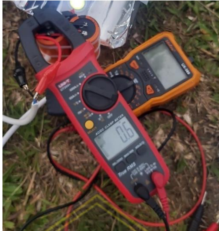
Gambar 5. 8 Pengukuran arus yang tersambung pada beban dan kapasitor
