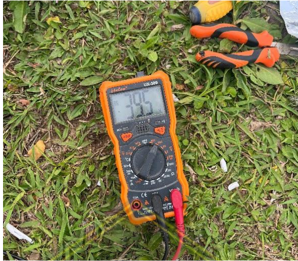
Gambar 5. 2 Pengukuran output tegangan generator tanpa beban
