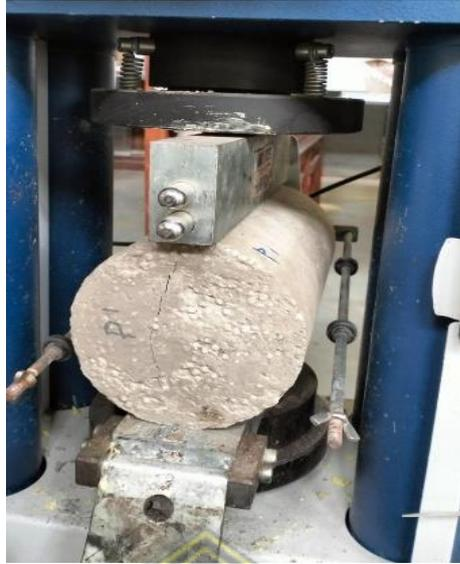
**Gambar 4.6 Pengujian Kuat Tarik Belah Benda Uji Silinder Umur 28 Hari**
