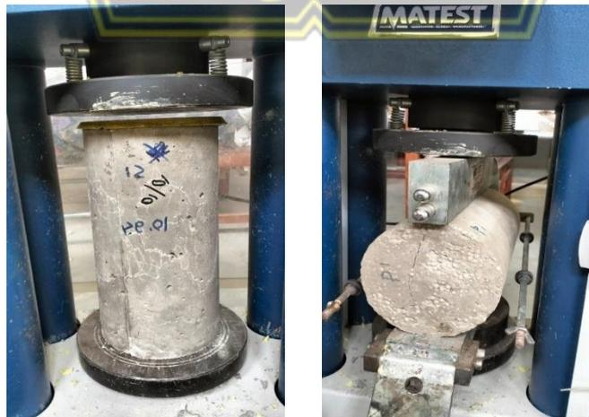
**Gambar 4.3: Pengujian Kuat Tekan dan Tarik belah Benda Uji Silinder Umur 28 Hari**
