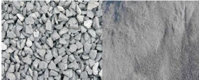
Gambar 2. 1 Gambar Agregat Kasar dan Agregat Halus Sumber: dokumentasi Proyek Simpang Susun Tol Serang-Panimbang Seksi 2, PT PP (2022)
