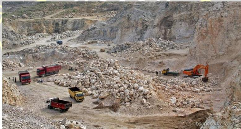
**Gambar 9.6** Proses Pemuatan Batu Kapur Menggunakan *Dump Truck*
