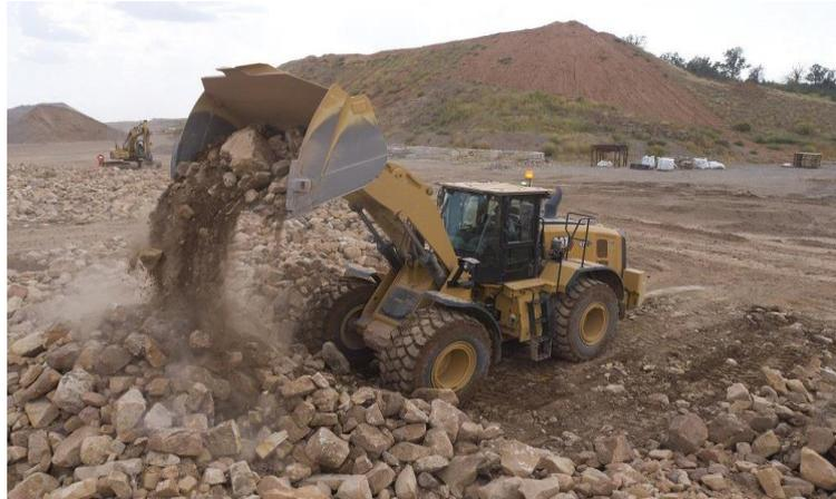
**Gambar 10.7** Proses Pengangkutan Batu Kapur Menggunakan *Wheel Loader*
