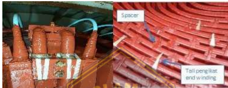
gambar 4. 9 hasil penambahan ikatan dan penguatan struktur belitan ujung
