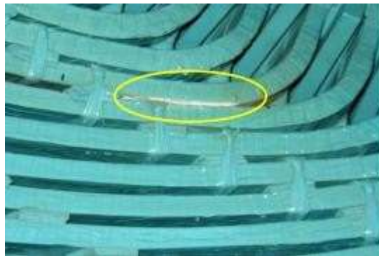
Gambar 2. 14 PD terjadi pada dua fase yang berbeda.[8]
