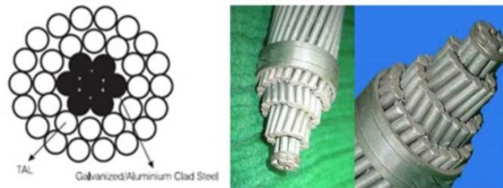
Gambar 2.3 Konstruksi Konduktor TACS[6]
