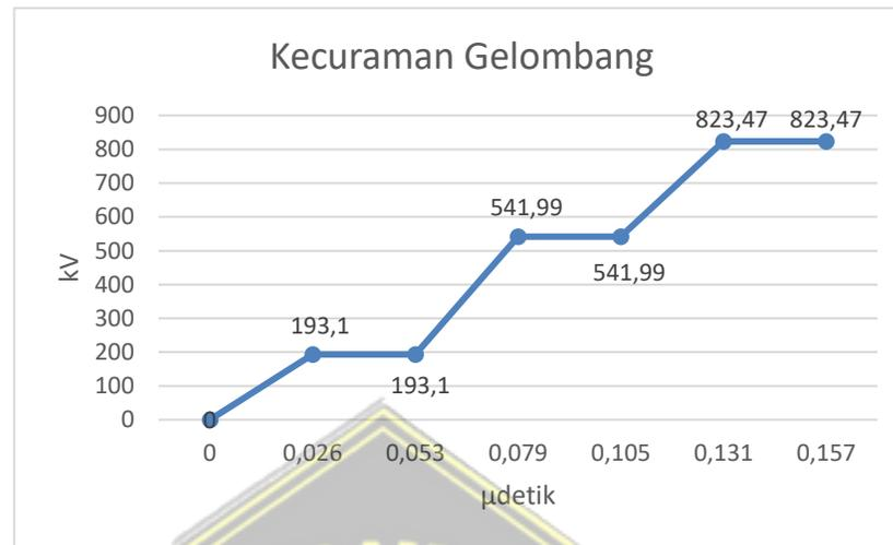
Gambar 4. 5 Grafik kecuraman gelombang surja petir dengan jarak 4 m.
