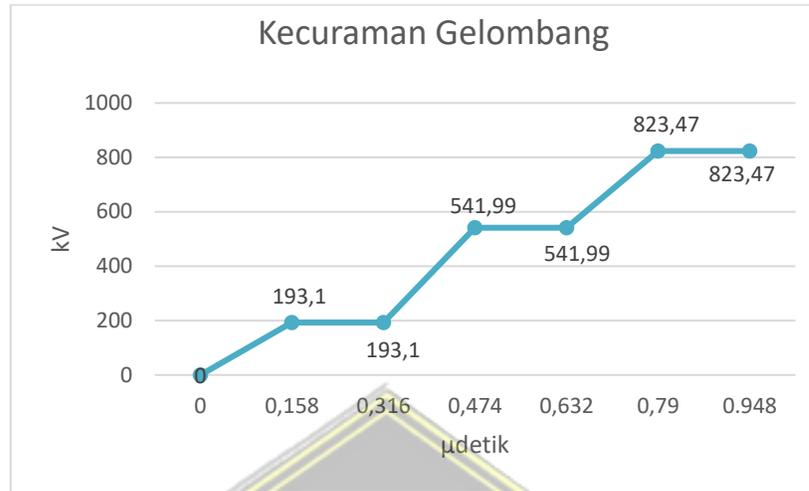
Gambar 4. 3 Grafik kecuraman gelombang surja petir dengan jarak 23,7 m
