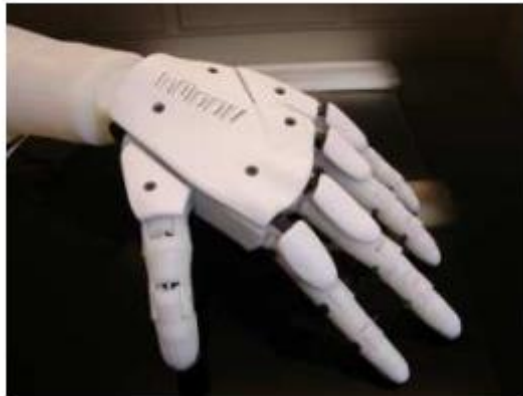
Gambar 3. 3 Tangan Robot rakitan InMoov [14]
