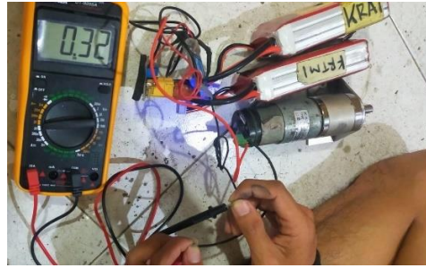
Gambar 4. 18 Hasil tabel pengukuran menggunakan multimeter 0.32 A.
