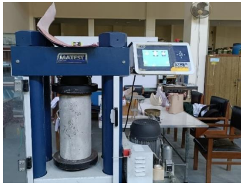
Gambar 4.26 Uji Kuat Tekan Beton
