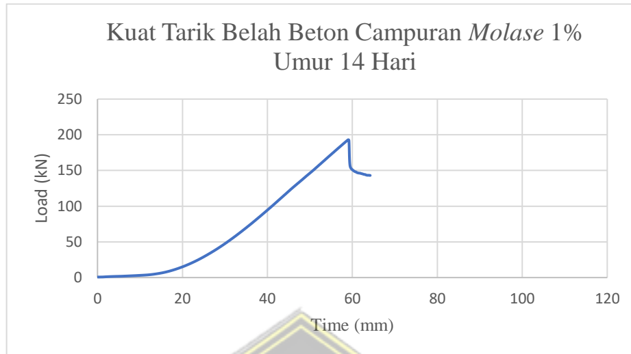
Gambar 4.37 Kuat Tarik Belah Beton Campuran Molase 1% Umur 14 Hari Dari hasil pembacaan Gambar diperoleh nilai Kuat Tarik Belah beton Campuran Molase 1% umur beton 14 hari adalah 2,73 MPa.
