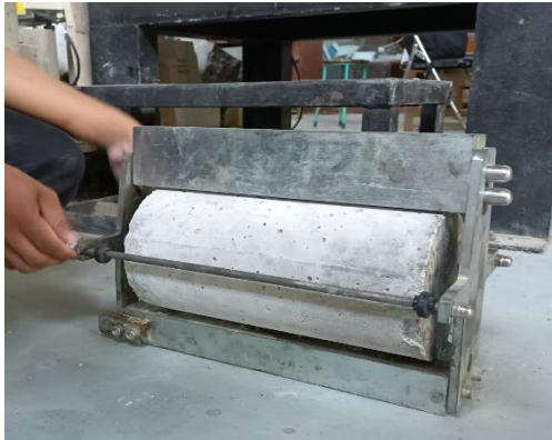
Gambar 4.45 Pemasangan Benda Uji
