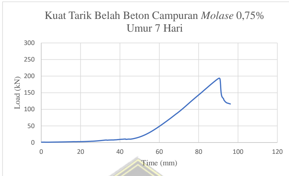
Gambar 4.31 Kuat Tarik Belah Beton Campuran Molase 0,75% Umur 7 Hari Dari hasil pembacaan Gambar diperoleh nilai Kuat Tarik Belah beton Campuran Molase 0,75% umur beton 7 hari adalah 2,74 MPa.
