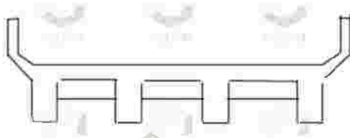
Gambar 2.3 Jembatan Beton Bertulang Balok T
