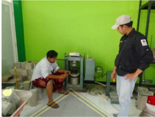
Gambar 4.1 Pengujian Kuat Tekan Paving Block Sumber : Dokumen pribadi peneliti,(2023)
