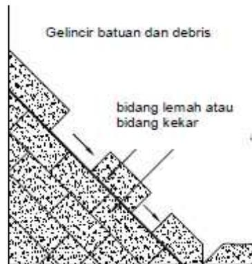
Gambar 2.6. Tipe gerakan keruntuhan lereng debris pada batuan
