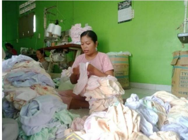
**Gambar 4. 11** Proses Pemotongan Sisa Benang
