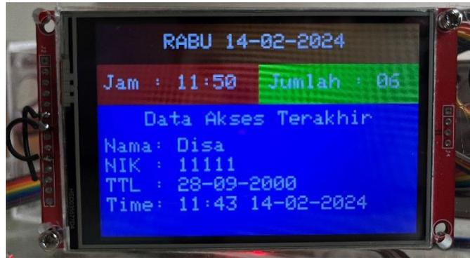
*Gambar 4. 11 Tampilan LCD TFT ketika melihat yang mengakses tempat penyimpanan terakhir*
