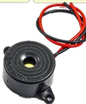
Gambar 2. 10 Bentuk fisik buzzer
