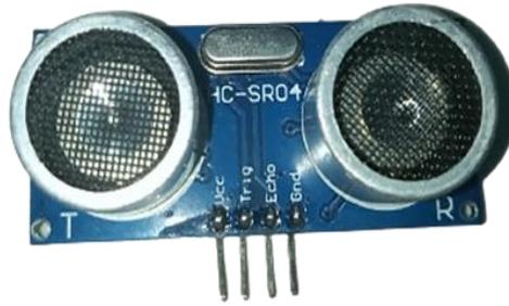
Gambar 2. 3 Bentuk fisik sensor ultrasonik
