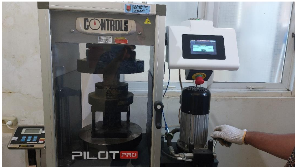
Gambar 4.6 Pengujian Kuat Tekan Paving Block
