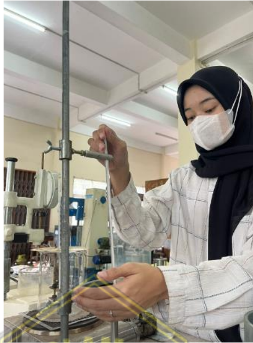
Gambar 4.4 Pengujian Titik Nyala dan Titik Bakar Aspal (Sumber: Dokumentasi Pribadi)
