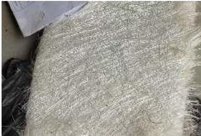
Gambar 4.2 Persiapan Bahan Serat Selulosa Sebagai Bahan Tambah ( Sumber : Dokumentasi Pibadi)
