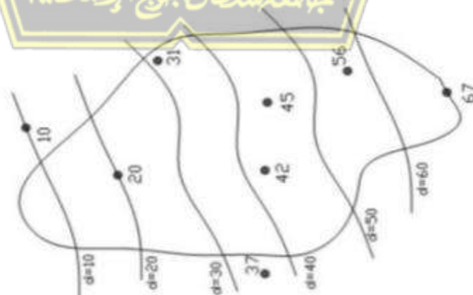
Gambar 2.4. Metode Isohyet Pada Suatu DAS
