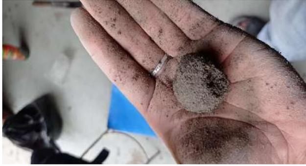
**Gambar 4.2** Pengempalan Adukan Dengan Kadar Air 300 ml
