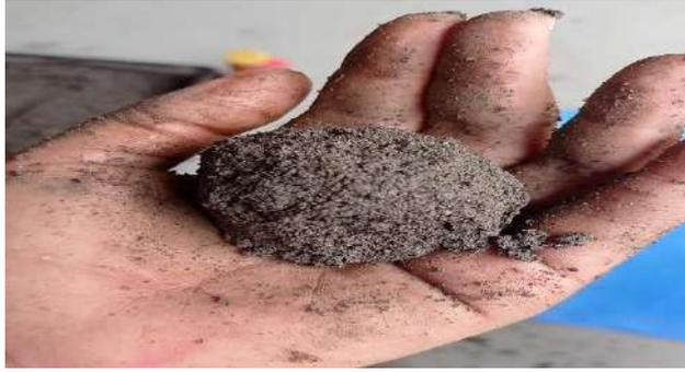
**Gambar 4.4** Pengempalan Adukan Dengan Kadar Air 500 ml
