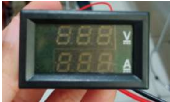
Gambar 3. 5 Volt Ampere digital
