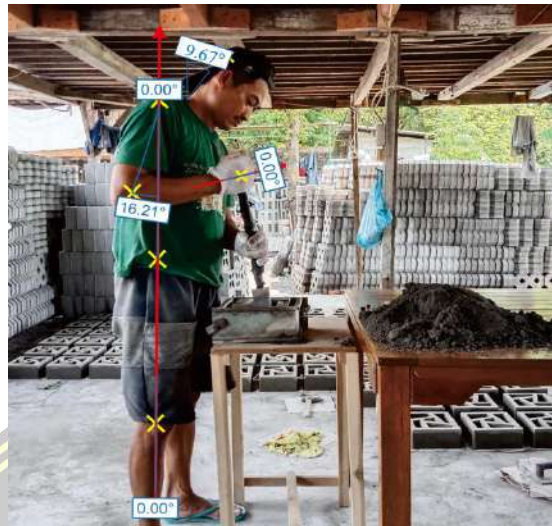
Gambar 4.25 Pemberian sudut pada proses pencetakan
