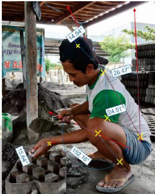
Gambar 4.11 Pemberian sudut pada proses pencetakan
