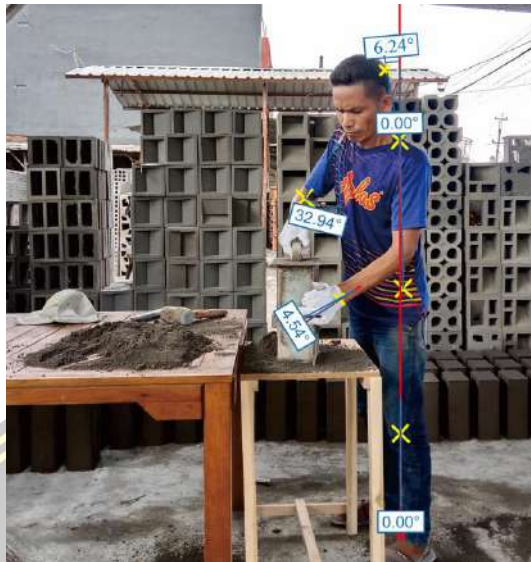
Gambar 4.20 Pemberian sudut pada proses pencetakan
