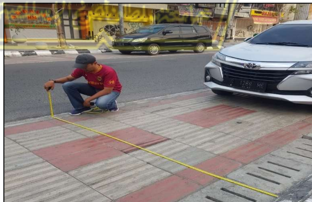
Gambar 4.2 Survey Karakteristik Jalan (lebar jalan)
