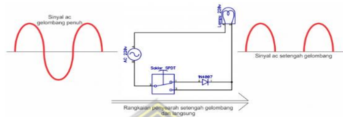
Gambar 3.14. Rangkaian Dimmer AC Sederhana
