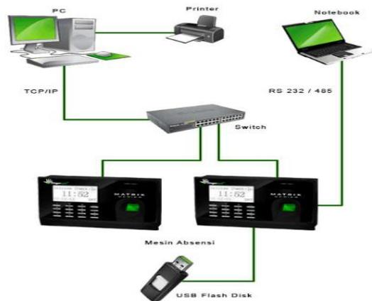
Gambar 4.2 Proses input data dari mesin Finger Print ke PC
