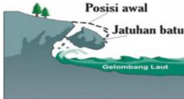
Gambar 2. 5 Longsor Runtuhan Batu Sumber: (Rusydy, 2016)
