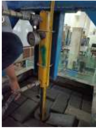
Gambar 4. 6 Sesudah diberi gaya vertical pada paving holland
