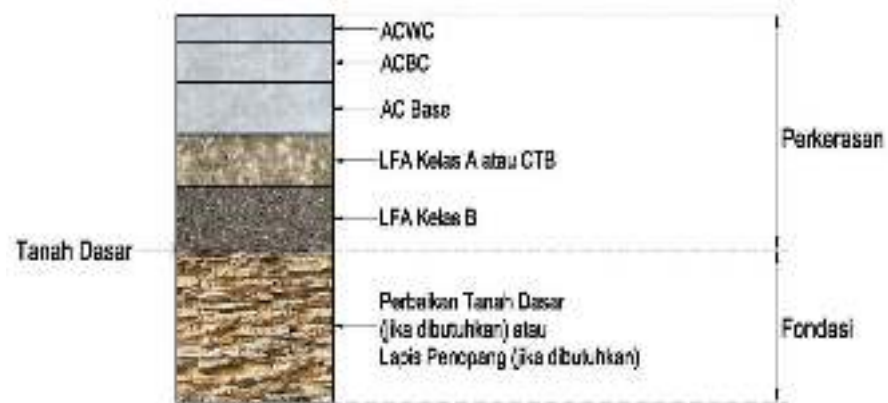
Gambar 2. 1 Potongan melintang perkerasan jalan lentur
