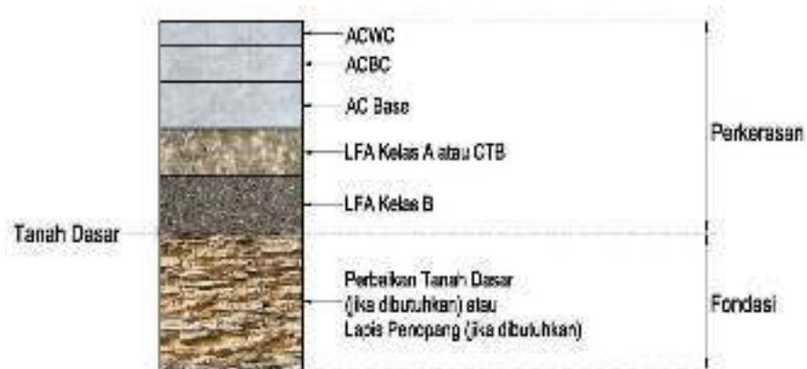
**Gambar 2. 1** Potongan melintang perkerasan jalan lentur
