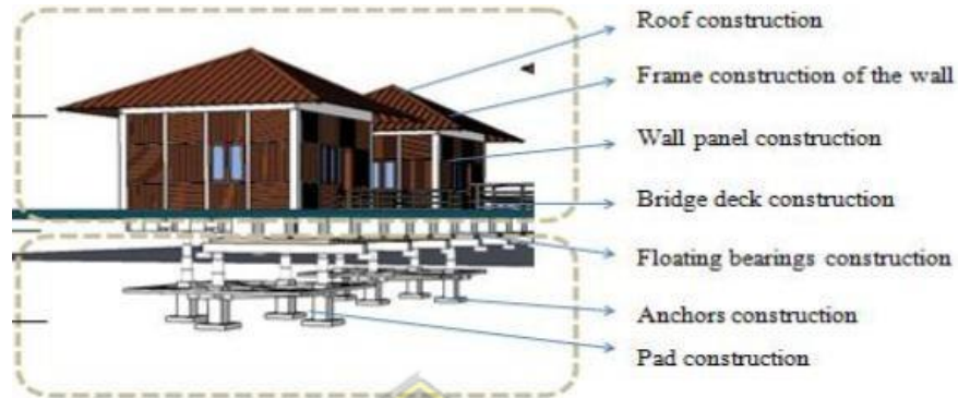
Gambar 2.3. Platform Apung dengan Pipa PVC
