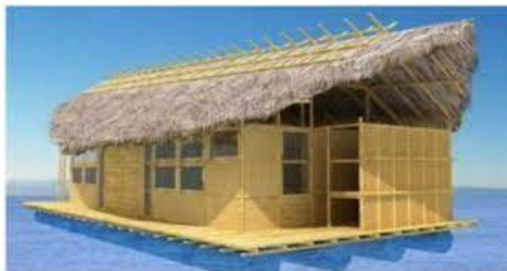
**Gambar 2.4.** Platform Apung dengan Bambu
