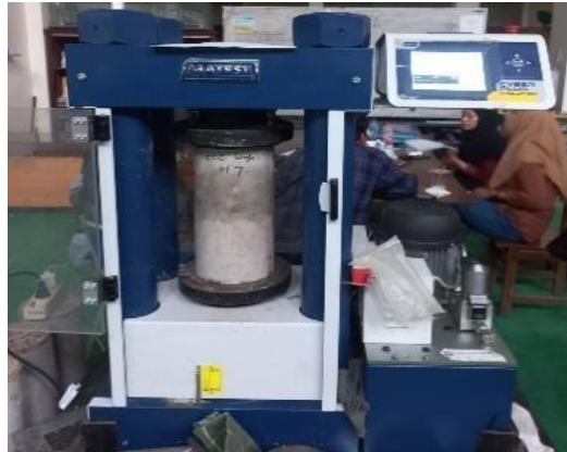
Gambar 2. 3 Alat Uji Kuat Tekan Beton (Sumber : Dokumentasi Pribadi)
